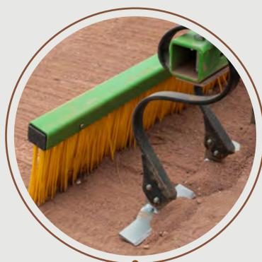
Couteaux avec revêtement au carbure fixés sur des socs à ressort (le couteau se met en retrait en cas de gros obstacle).
