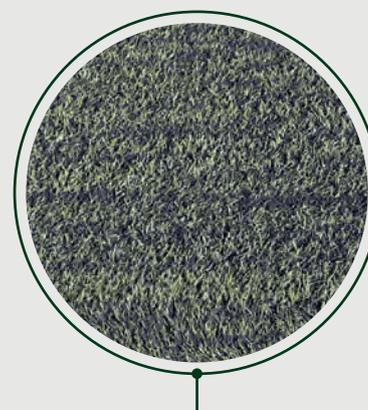
Après le passage, le granulat est décompacté. La fibre a été brossée et redressée.
