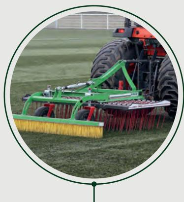
Décompactage/brossage réalisé à grande vitesse : 30-45 min pour 8 000 m<sup>2</sup> entre 8 et 12 km/h.
