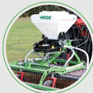
Regarnissage des surfaces avec le **kit semoir**. La semence est soufflée de manière homogène entre les dents.
